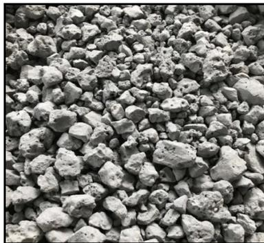
Figure 1: Steel slag
